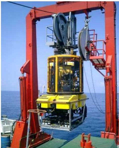
3500 米深海观测和取样型 ROV “海龙号”
