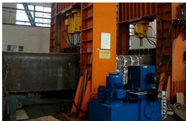
船体结构极限强度试验
