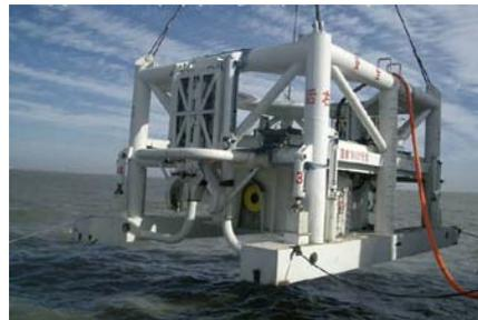
浅海海底管线电缆检测和维修装置
