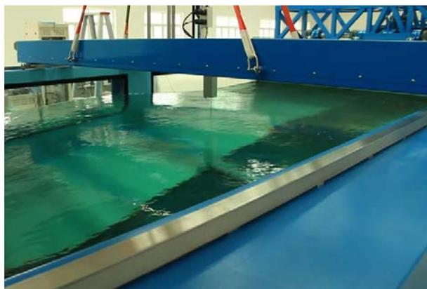
循环水槽中造波实验 (顺流流速 0.5m/s)
